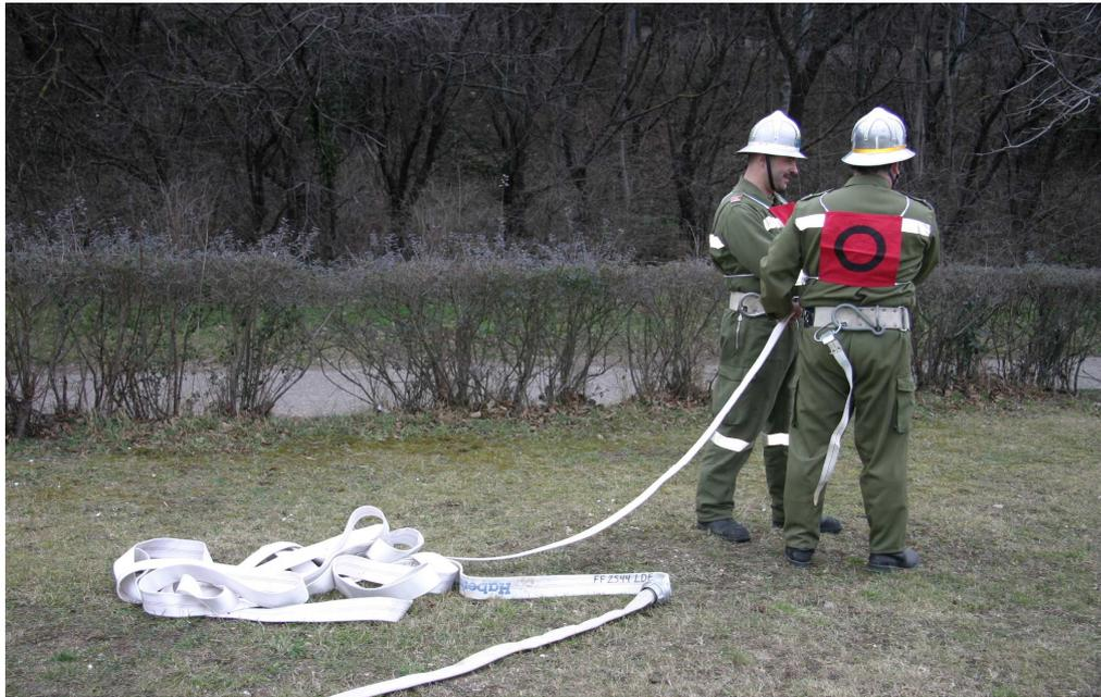
Abb. 21a Schlecht ausgelegter Druckschlauch „Haufen“
