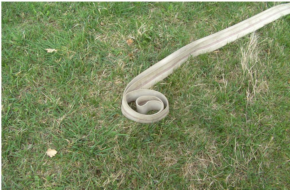
Abb. 21b Schlecht ausgelegter Druckschlauch „Schnecke“
