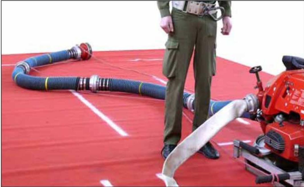
Abb. 16: Befestigen Saugschlauchleine an der TS
